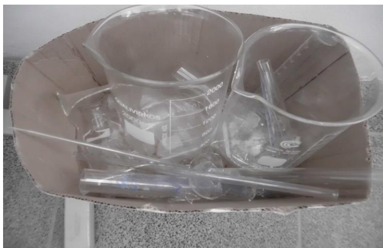
Figura 2: Descarte incorreto de vidraria quebrada
