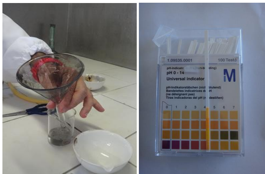
Figura 6: Raspagem da fuligem e pH resultante
