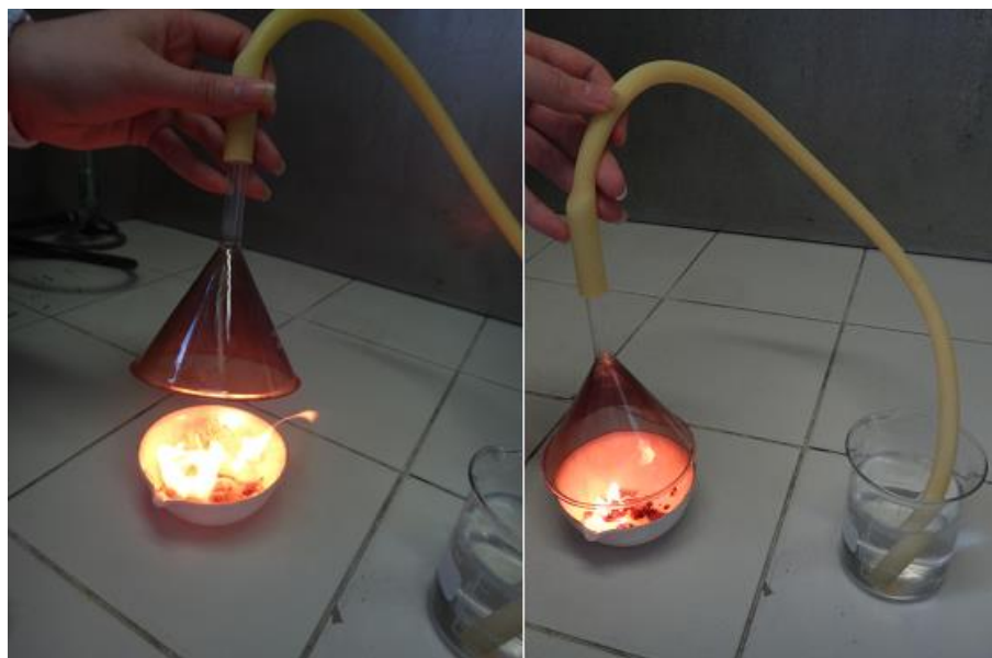
Figura 5: Queima da poliuretana e direcionamento do gás
