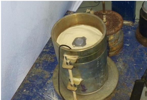
Figura 2. Preenchimento do molde e instalação da célula
