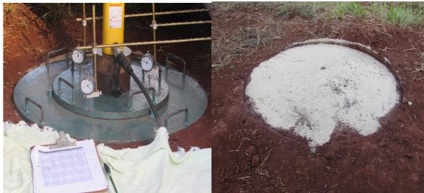
Figura 6 – Ruptura por punção placa 80 cm
