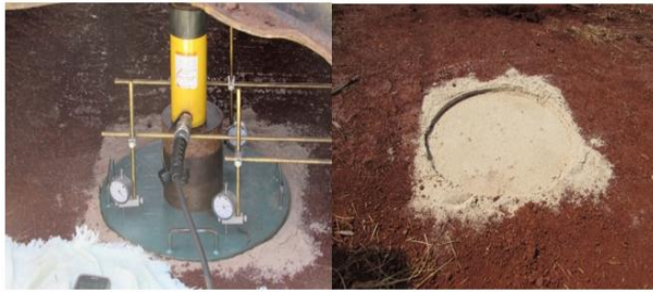
Figura 6 – Ruptura por punção placa 80 cm
