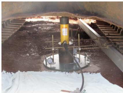
Figura 2 – Ensaio de placa de 48 cm de diâmetro
