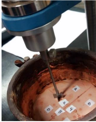
Figura 4 - Detalhamento da palheta preparada e centralizada no ponto para a cravação na amostra.
