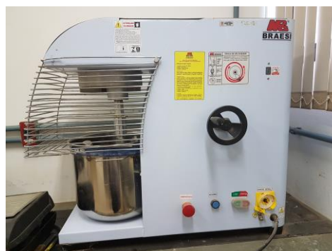
Figura 1 – Misturador mecânico para preparação do solo artificial.
