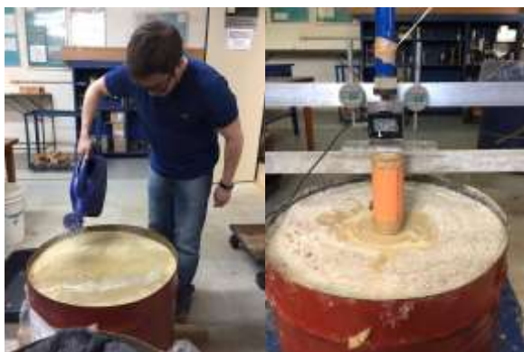
Figura 3. Aplicação do ensaio de placa no CP_03Biocimentado.
