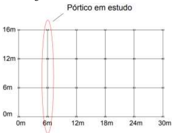
Figura 2. Planta baixa estrutural
