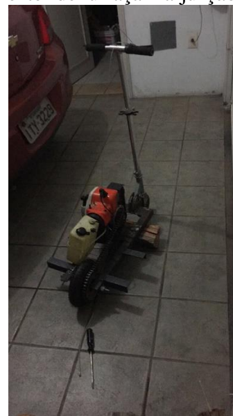
Figura 3. Patinete montado ainda com o tanque de combustível na parte traseira.
