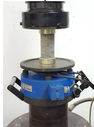
Figura 1. Rompimento dos corpos de prova à compressão
