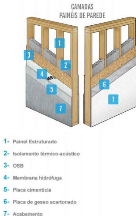
Figura 1 – Camadas método Wood Frame
