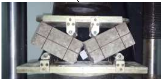
Figura 4 – Corpo de prova com ruptura no terço médio
