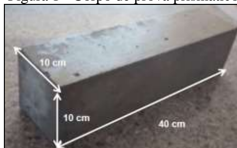
Figura 1 - Corpo de prova prismático
