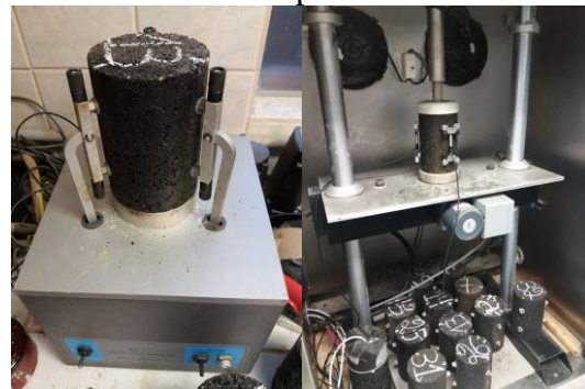
Fig 3. Colagem de pinos e ensaio de Módulo Complexo
