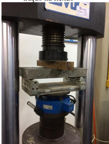
Figura 2. Rompimento dos corpos de prova à tração na flexão
