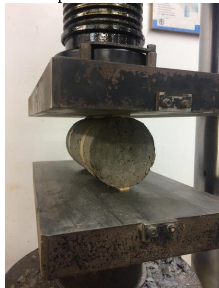
Figura 1. Rompimento dos corpos de prova à compressão diametral
