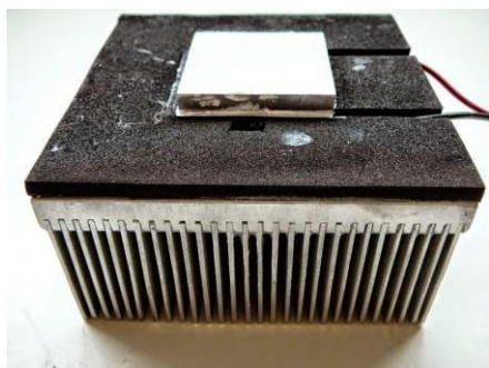
Figura 5. Célula Peltier ligada ao dissipador de calor.
