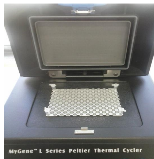
Figura 3. Bloco térmico, com os tubos de amostra.
