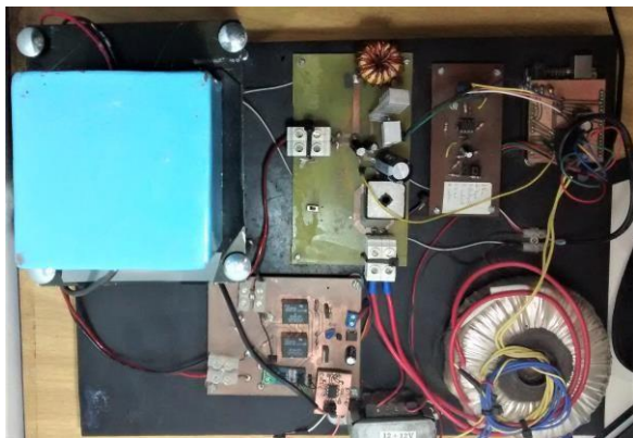
Figura 8. Foto do protótipo do termociclador automático.
