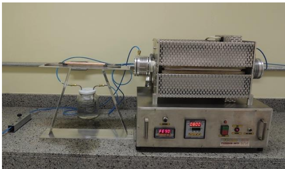
Figura 2. Aparato experimental utilizado no processo de sinterização de pó metálico
