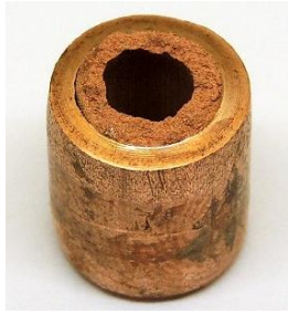
Figura 1. Estrutura capilar de pó de cobre sinterizado
